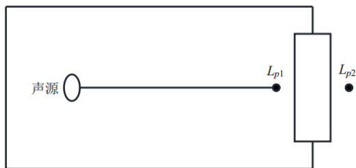
图 4-3 室内声源等效为室外声源图例
